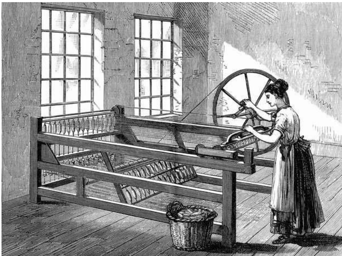
Figura 3 – Máquina de fiar de fios múltiplos Fonte: site eHow Brasil
